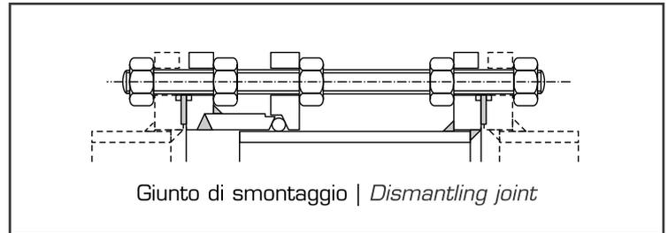
Giunto di smontaggio | *Dismantling joint*
