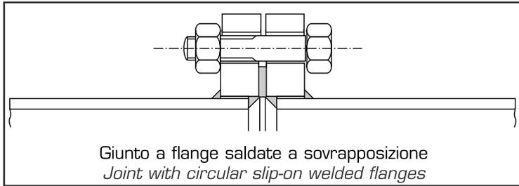
Giunto a flange saldate a sovrapposizione
