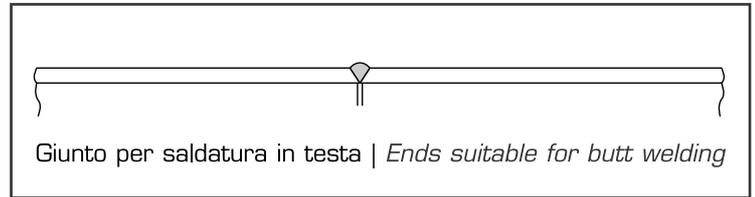
Giunto per saldatura in testa | *Ends suitable for butt welding*
