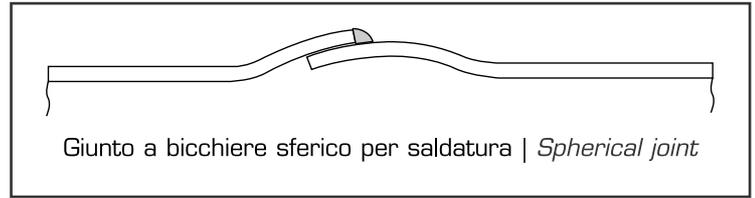
Giunto a bicchiere sferico per saldatura | *Spherical joint*
